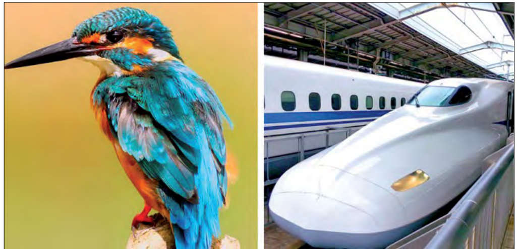
FIG. 1. L'aerodinamica del famoso treno giapponese Bullet è stata ispirata dalla forma del becco del Martin Pescatore. Gli ingegneri hanno progettato una forma simile da montare sulla parte anteriore del treno così che al suo passaggio questo separi l'aria piuttosto che comprimerla, risolvendo il problema del boato.
